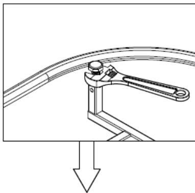
Plaats het bad op zijn definitieve plaats en lijn het bad uit d.m.v. een waterpasser en door de poten onderaan het bad bij te regelen.
