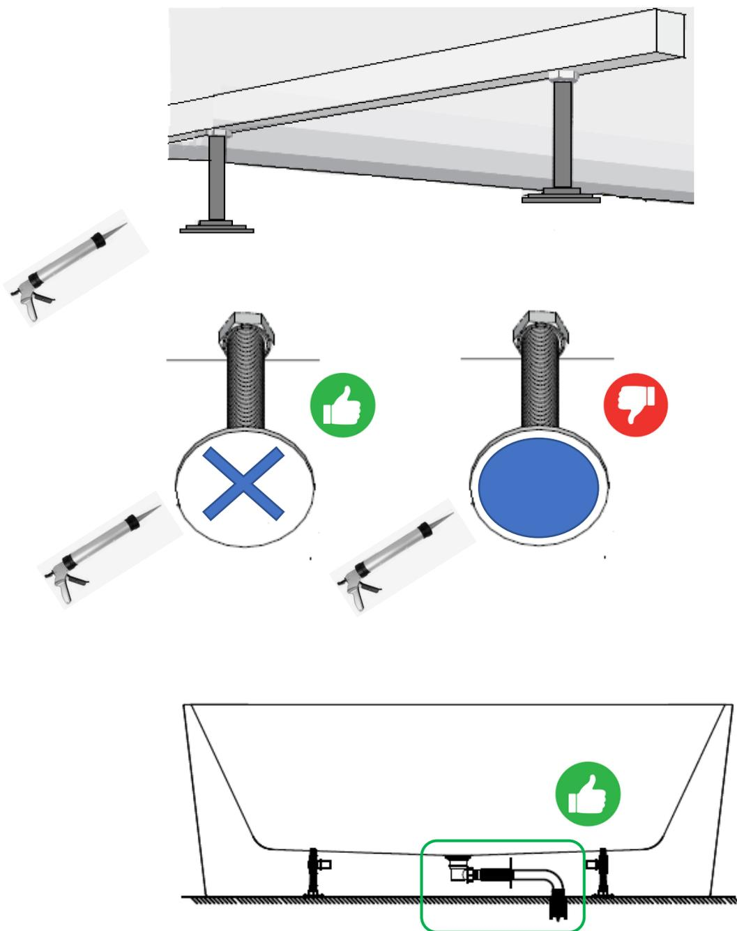
Breng een kleine hoeveelheid sanitaire siliconen op de 4 poten aan en plaats het bad op zijn definitieve plaats. Dit zal voorkomen dat het bad kan verschuiven bij gebruik. Let goed op dat de flexibel van de sifon niet gedraaid of gekneld zit. Laat de siliconen 24u drogen voor de eerste ingebruikname !
