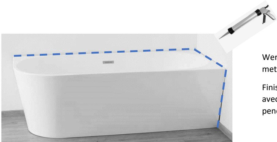
Werk de voegen af van het bad met de muur met sanitaire siliconen en laat 24 u drogen.
