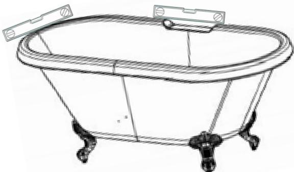
4. Plaats het bad op zijn definitieve plaats en lijn het bad uit d.m.v. een waterpasser en door de poten onderaan het bad bij te regelen.
