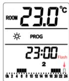
Na het instellen van uur 23 springt het automatisch naar uur 0 enzovoort. Na het instellen, druk kort op de **OK**-knop om te bevestigen, af te sluiten en terug te keren naar de **PROG**-knop en de selectie-instellingeninterface, weergegeven als
