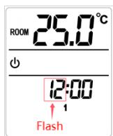
4.2.5. **Minuut aanpassen:** Druk kort op de **OK**-knop, de minuut knippert. Druk kort op **▲** of **▼** om aan te passen, het aanpassingsbereik is 0~59, stap voorwaarts 1 min. Lang indrukken heeft een acceleratiefunctie, weergegeven als
