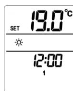
dernière fois, affiché comme . Appuyez brièvement sur **▲** ou **▼** pour régler la température, par pas de 0,5 °C. Une pression longue a une fonction d'accélération. Lorsque le réglage est terminé, la température affiche la température
