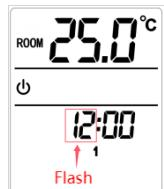
4.2.5. **Réglage des minutes:** Appuyez brièvement sur le bouton **OK**, les minutes clignotent. Appuyez brièvement sur **▲** ou **▼** pour ajuster, la plage de réglage est 0~59, incrément de 1 minute. Une pression longue a une fonction d'accélération,
