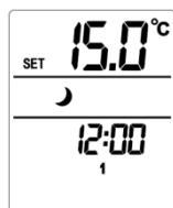
7~30 °C, weergegeven als Druk kort op of om de temperatuur in te stellen, stap voorwaarts 0,5 °C. Lang indrukken heeft een acceleratiefunctie. De insteltemperatuur kan niet hoger zijn dan de comforttemperatuur. Zodra de instelling voltooid is, toont de temperatuur de binnentemperatuur, weergegeven als
