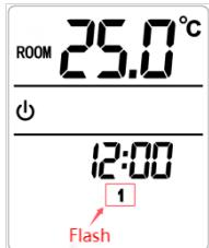
4.3. **État de mise sous tension:** Une courte pression sur **⊕** permet d'entrer dans le dernier mode de fonctionnement, affiché comme
