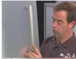
3.3 Installez la charnière sur la porie en verre, horizontalement et de niveau avec le flanc de la porie en verre. Placez ensuite la pince de la serrure dans le sens de rotation voulu et vérifiez si la serrure fonctionne correctement avant de la monter dans le panneau de porte.
