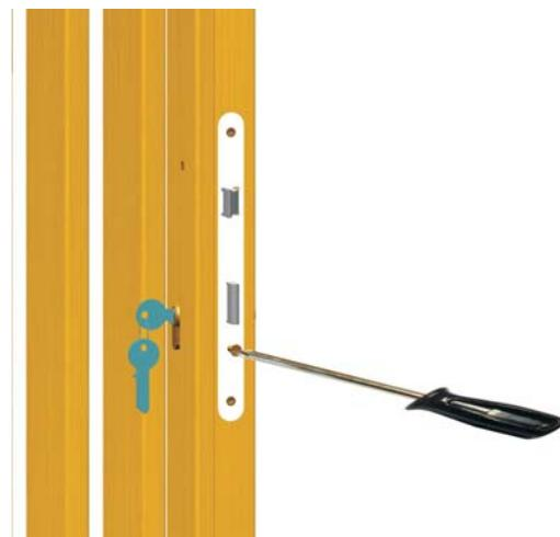
N°11: Pose des ensembles plaque béquille à l'aide des vis à douille fournies.
