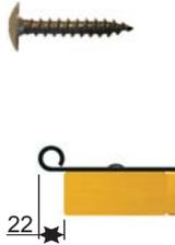
N°4: Pose de la serrure à l'aide des 2 vis VBA diam 3.5 x 25 mm.
