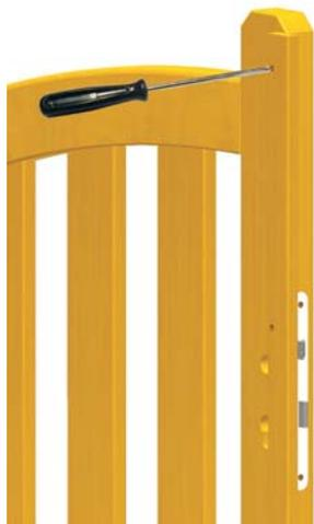
N°10: Pose du cylindre à l'aide de la vis métaux de diam 5 x 45 mm.
