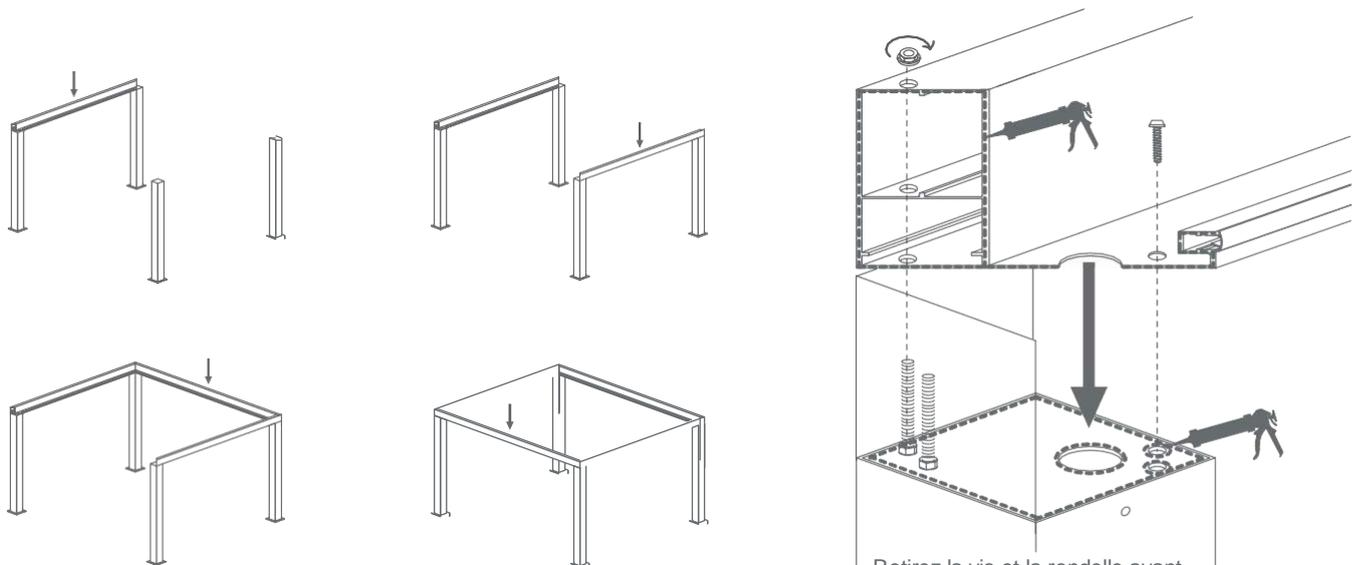
Retirez la vis et la rondelle avant de placer la gouttière contre le pilier. Une fois la gouttière est correctement positionné, fixez-le à l'aide de la vis.
