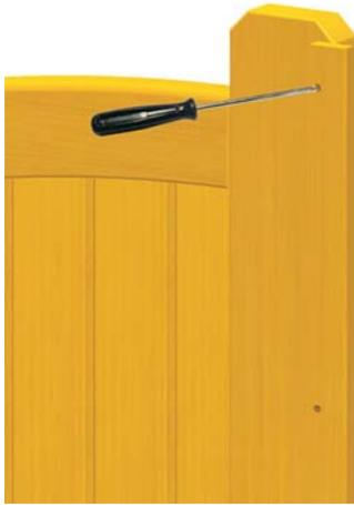
N°10: Pose du cylindre à l'aide de la vis métaux de diam 5 x 45 mm.
