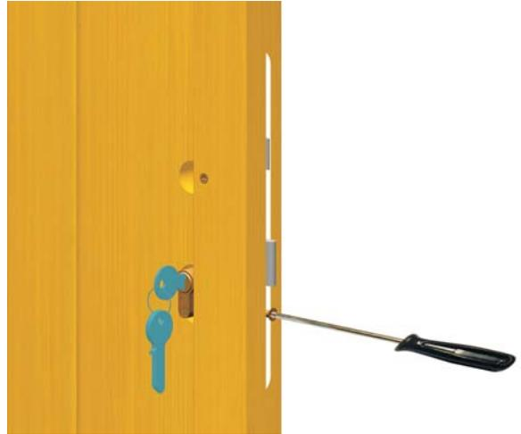
N°11: Pose des ensembles plaque béquille à l'aide des vis à douille fournies.
